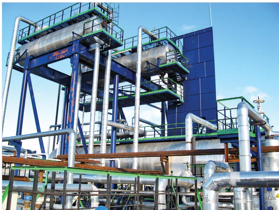
Фото 1. Разделительные сепараторы на установке подготовки нефти
