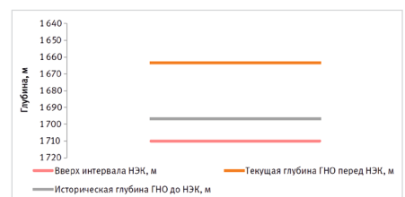
Рис. 9. Распределение средних глубин НЭК, текущей и исторической глубин спуска ГНО Fig. 9. Distribution of the average depths of leakage, the current and historical depths of downhole pumps
