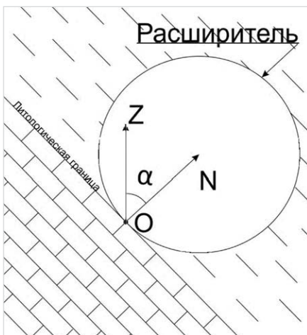
Рис. 9 — Схема взаимодействия расширителя с породой на литологической границе
