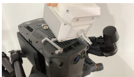
Фото 1. Установка Sniffer 4D на летную платформу DJI Matrice 300 RTK
