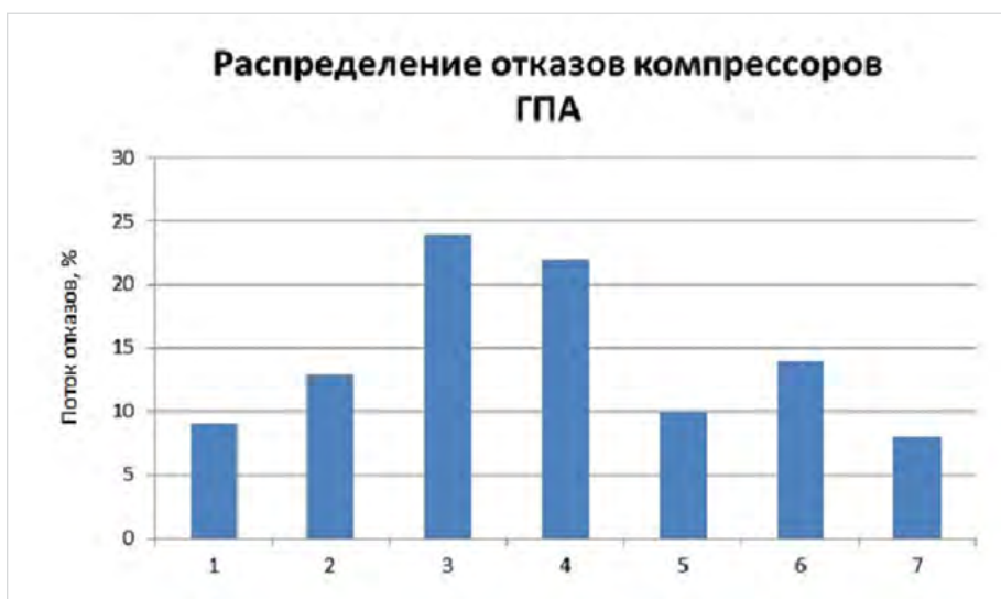
Рис. 1 — Распределение отказов компрессоров ГПА 1 – повреждения проточной части; 2 – повреждения роторной группы; 3 – повреждения системы регулирования; 4 – повреждения подшипников; 5 – повреждения маслосистемы; 6 – повреждения трубопроводов и арматуры; 7 – повышенная вибрация
