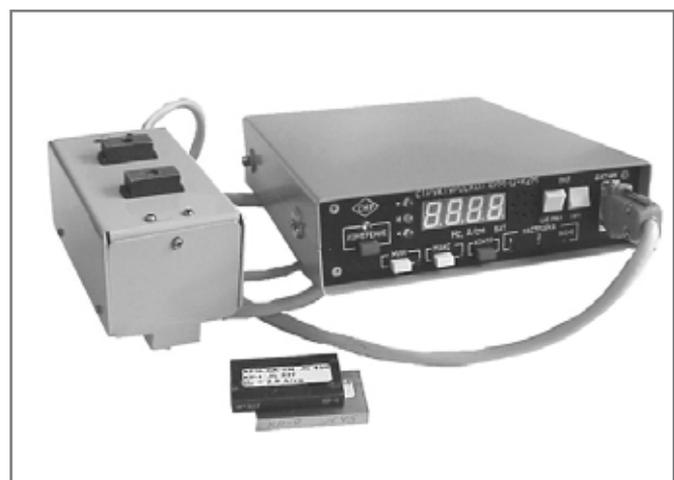
Рис.2. Магнитный структуроскоп КРМ-Ц-К2М
