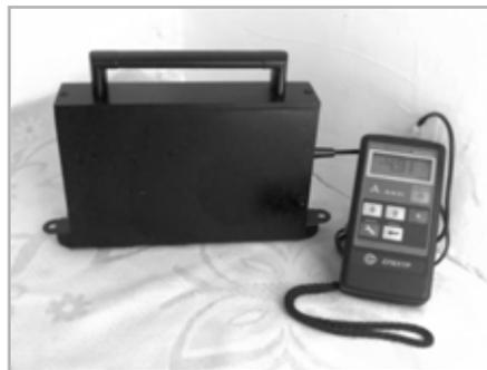
Рис.7. Индикатор механического напряжения металла ИН-02
