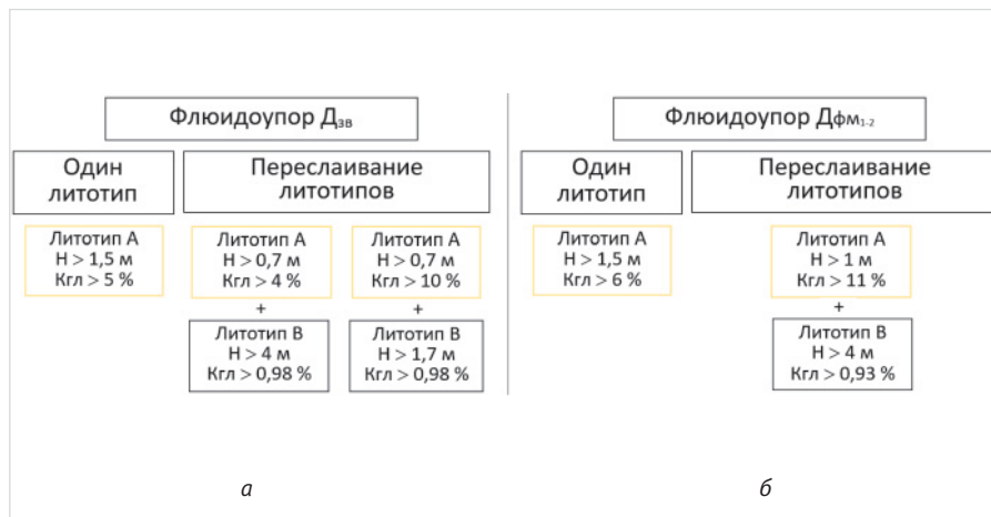
Рис. 5. Геофизические критерии выделения предполагаемого флюидоупора верхнедевонской карбонатной толщи в интервалах пластов: а — D_{zv} ; б — D_{fm1-2} Fig. 5. Geophysical criteria selection of the seal rock Upper Devonian carbonate deposits: а — layer D_{zv} ; б — layer D_{fm1-2}
