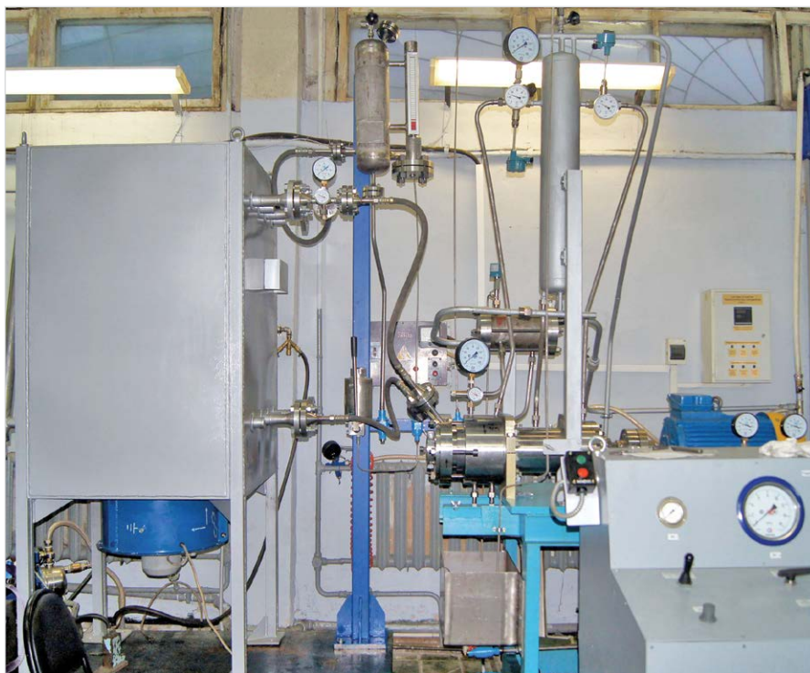
Рис. 2 — Один из испытательных стендов с аппаратом воздушного охлаждения
