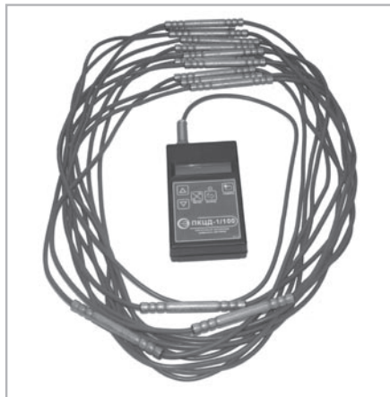
Рис. 1 Термокоса (МЦДТ 0922) с контроллером (ПКЦД-1/100)
