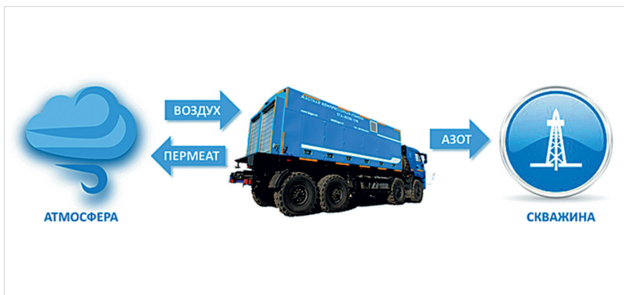
Рис. 2. Схема процесса получения газообразного азота из воздуха
