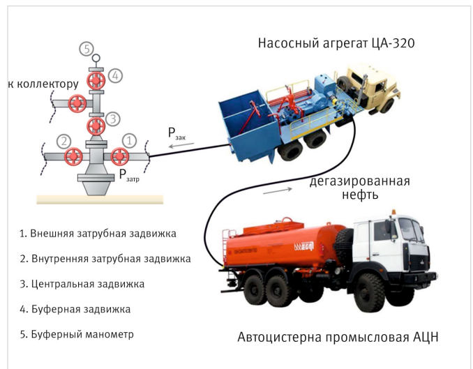
Рис. 7. Процесс закачки ДГН Fig. 7. De-gassed oil injection process
