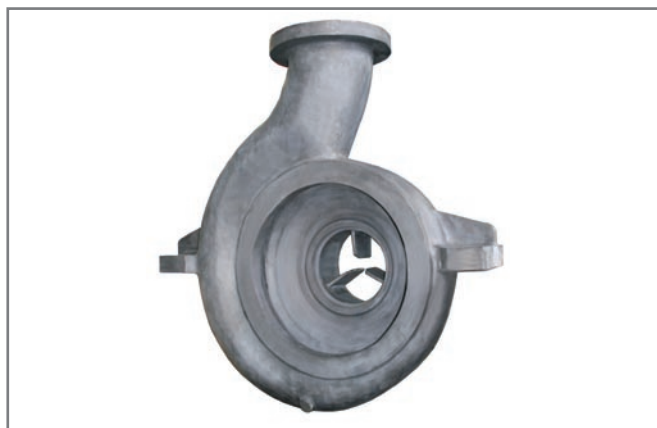
Рис. 5 Корпус насоса для норвежской фирмы «Аэротитаниум АС». Заливка формы осуществлялась на уникальной печи «Нева-5» из титанового сплава массой 2160 кг. черновой вес отливки 1091 кг. Отливка имеет крупногабаритную (высота – около двух метров), сложную и нетехнологичную конструкцию. Корпус насоса предназначен для химической промышленности
