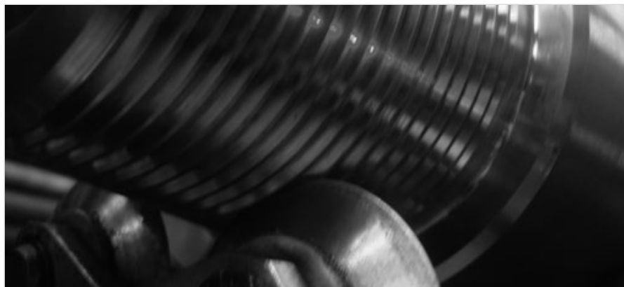
Рис. 3 — Пример обкатки резьбовой поверхности роликом
