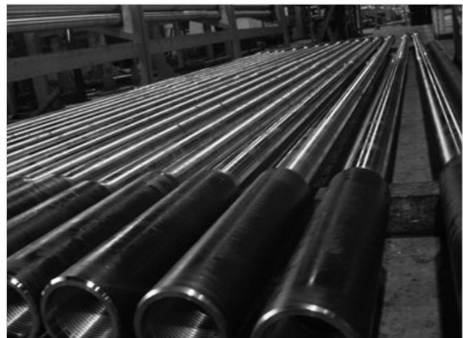
Рис. 2 — Муфтовая часть утяжеленной бурильной трубы
