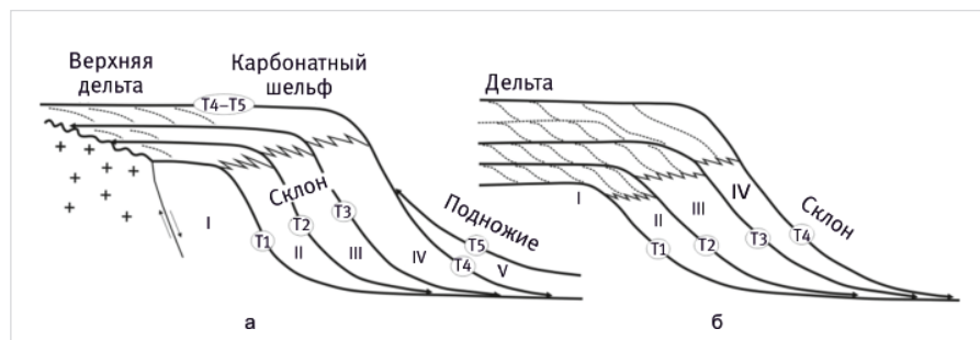
Рис. 2. Схематическое изображение сеймо-стратиграфических единиц — системных трактов (на основе рис. 4 из [20]): T1–T5 — опорные временные поверхности, I–V — сеймо-стратиграфические единицы — системные тракты Fig. 2. Schematic representation of seismostratigraphic units — systems tracts (based on fig. 4 from [20]): T1–T5 — reference time surfaces, I–V — seismostratigraphic units — systems tracts
