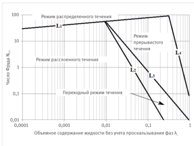
Рис. 1. Карта режимов течения Беггса и Брилла [9] Fig. 1. Beggs and Brill flow pattern map [9]
