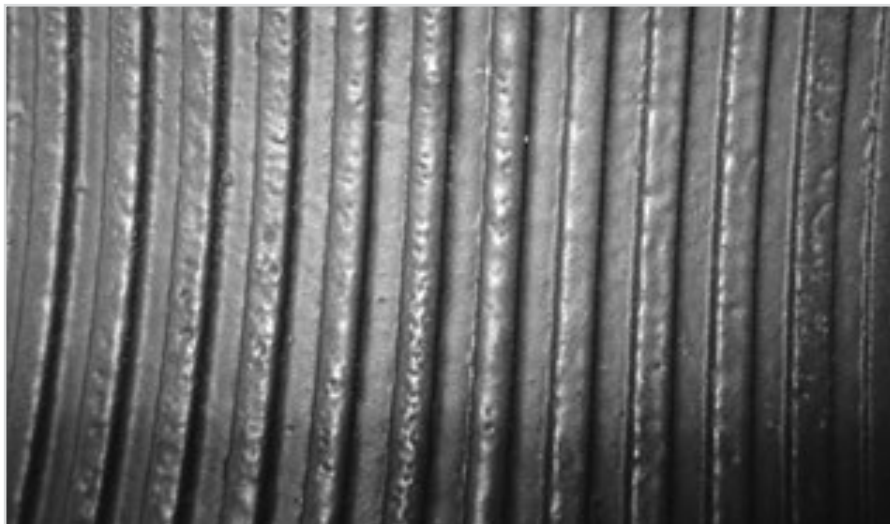
Рис. 2 — Внешний вид резьбы Баттресс производства ОАО «ТАГМЕТ» с фторполимерным самосмазывающим сухим покрытием «МАОК-ПЛАУН™»
