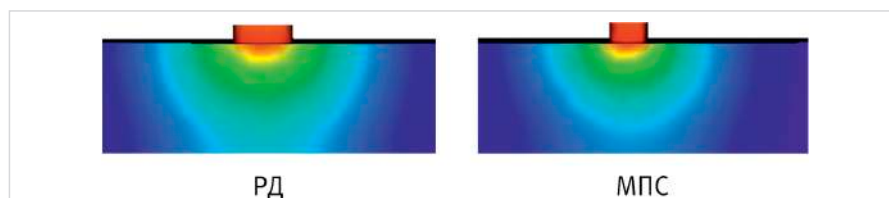
Рис. 4 — Распределение тепла при РД и МПС наплавке (время нагрева 1 с)
