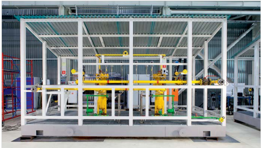
Блок отсекающей арматуры (БОА). Завод GEA, г. Климовск
