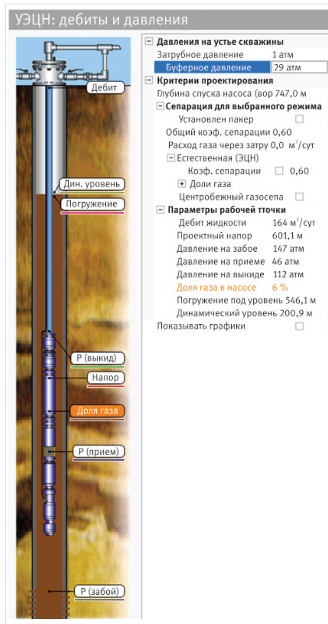
Рис. 4. Количество газа на приеме насоса при буферном давлении 2,9 МПа = 6 % Fig. 4. The gas quantity at the pump intake at a buffer pressure of 2,9 MPa = 6 %
