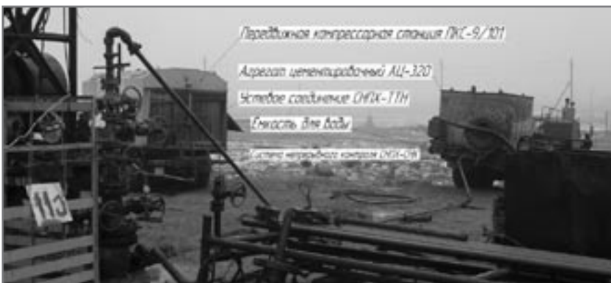
Рис. 5. Комплекс оборудования для проведения внутрискважинного синтеза оксидата
