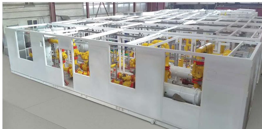
Фото 13. Многомодульная установка подготовки топливного газа на этапе цеховой сборки
