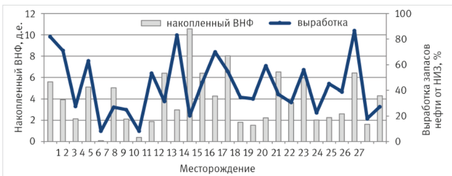
Рис. 1. Соответствие выработки запасов нефти от начальных извлекаемых запасов (НИЗ) и водонефтяного фактора по месторождениям Компании Fig. 1. Compliance of the development of oil reserves from the IRR and the water-oil factor for the Company's fields
