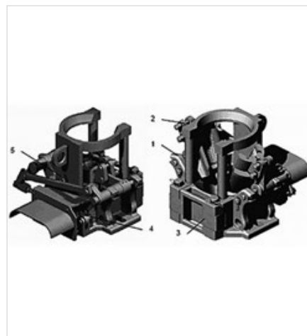
Рис. 2 — Общий вид спайдера СПГ-80 1 — корпус, 2 — блок клиньев и вкладышей, 3 — дверца, 4 — цилиндр, 5 — система рычагов с защелкой
