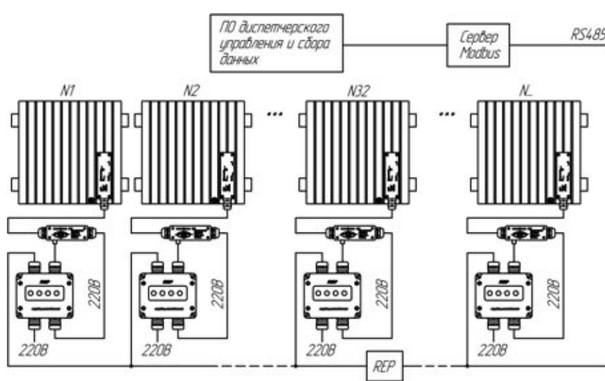
Рис. 3. Пример объединения обогревателей РИЗУР ОША-Р в промышленную сеть (подключение к системе SCADA).
