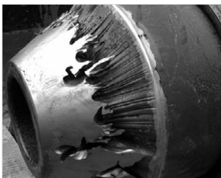
Рис. 3 — Кавитационная эрозия исполнительного органа клапана-регулятора
