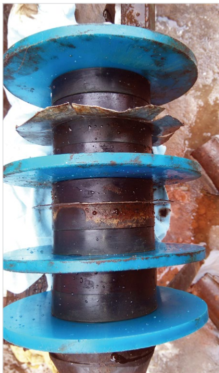
Рис. 1 — Вид скребка-калибра после прогона по трубопроводу 159х6 мм, 5,5 км
