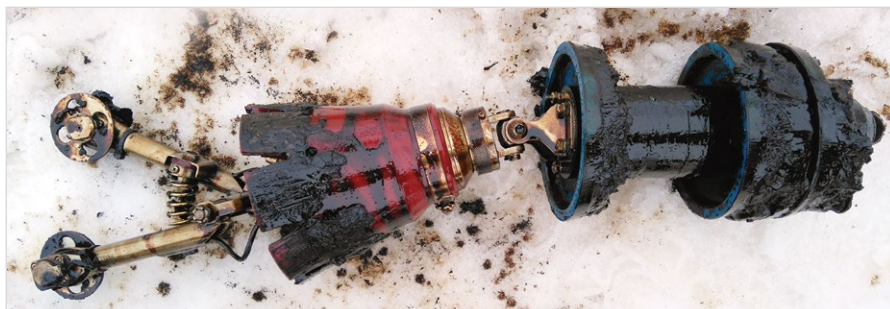
Рис. 2 — Профиломер ПВМ-6-159 после прогона по трубопроводу 159х6 мм, 5,5 км
