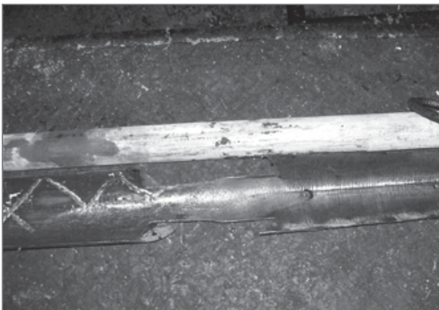
Рис. 5 Верхняя часть клина после вырезания «окна»
