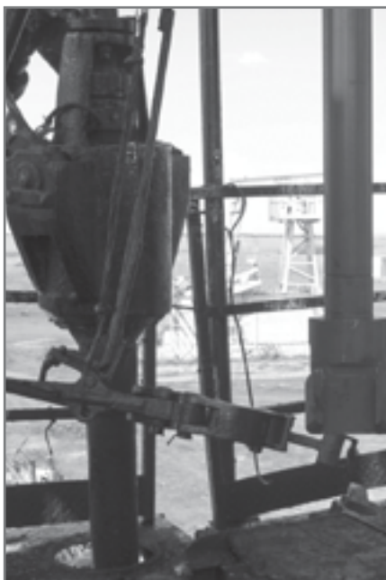
Рис. 2 Спуск съемника отклонителя в скважину
