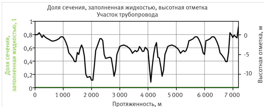
Рис. 5. Накопление жидкости после 20 минут «очистки» на участке от т. вр. К-12 до УКПГ Fig. 5. Accumulation of liquid after 20 minutes of «cleaning» in the area from insertion point K-12 to UKPG
