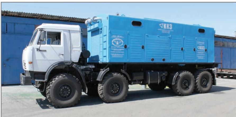
Рис.1. ТГА 10/251 С 95 на шасси КАМАЗ 63501. Производительность – 10 м<sup>3</sup>/мин; Давление – 251 атм; Чистота азота – 95%.
