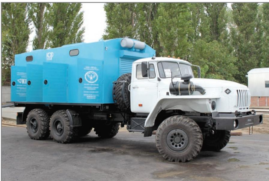
Рис. 3. ТГА 5/101 С 95 на шасси УРАЛ. Производительность – 5 м<sup>3</sup>/мин; Давление – 101 атм; Чистота азота – 95%.
