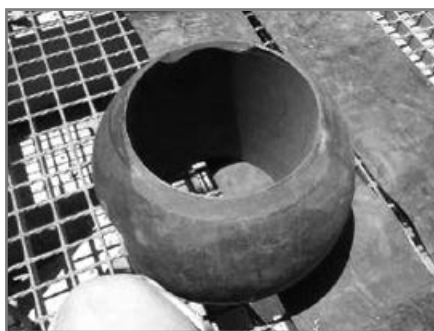
Рис.2. Износ титанового шара.
