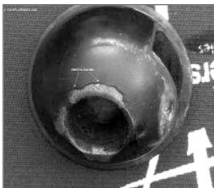
Рис.3. Износ титанового шара с покрытием.
