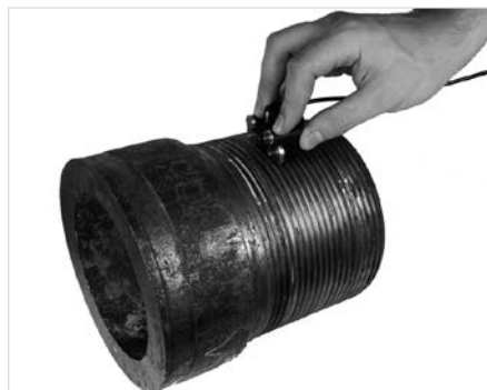
Рис. 9 – Каретка с ВТП, установленная на отрезок ниппельного конца буровой трубы
