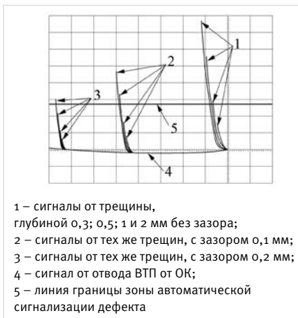
Рис. 7 – Изображение дисплея дефектоскопа с комплексной плоскостью
