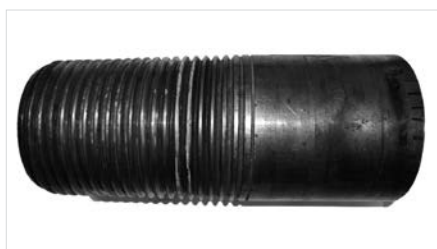
Рис. 2 — Фотография трубы с резьбой Ø88x123, бывшей в употреблении
