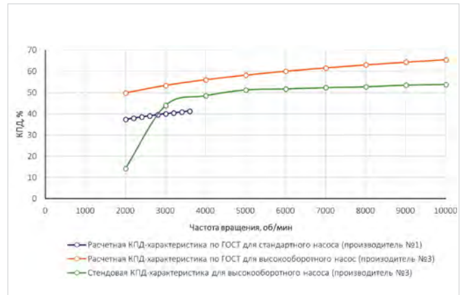
Рис. 4 — Расчетные (паспортные) и стендовая КПД-характеристики насосов производителей №1 и №3 Fig. 4 — Estimated and bench efficiency curve of pumps from vendors №1 and №3
