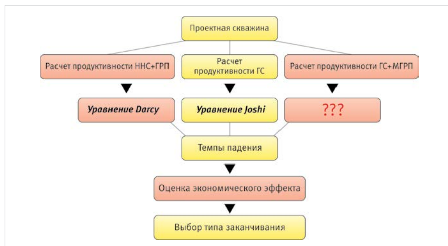
Рис. 1 — Выбор типа заканчивания проектной скважины
