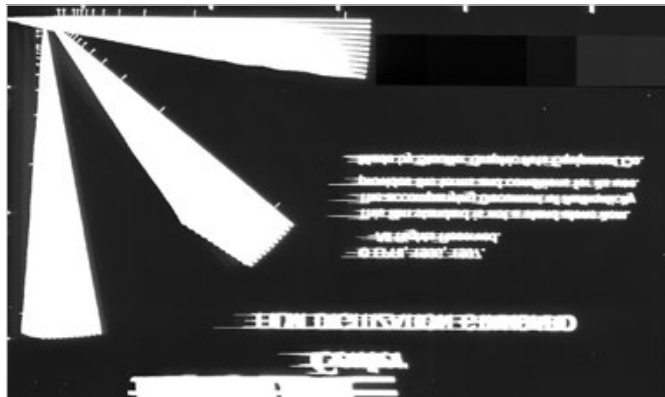
Рис. 1 — Размытие EPRI сканером Microtek MII 900 Plus при разрешении 300 dpi и максимальной экспозиции
