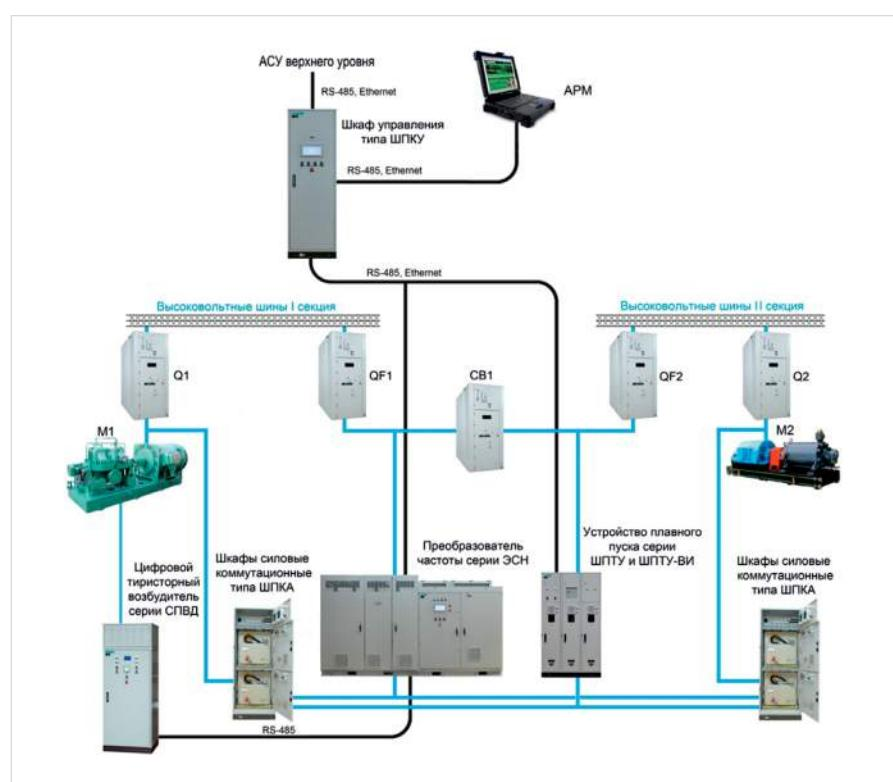
Рис. 1 — Схема АСУ ТП электропривода насосных агрегатов
