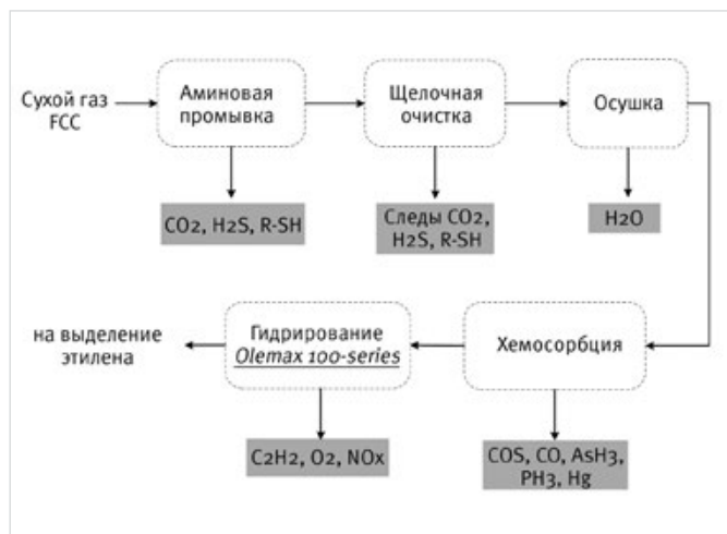
Рис. 2 — Схема очистки сухого газа. Вариант 1
