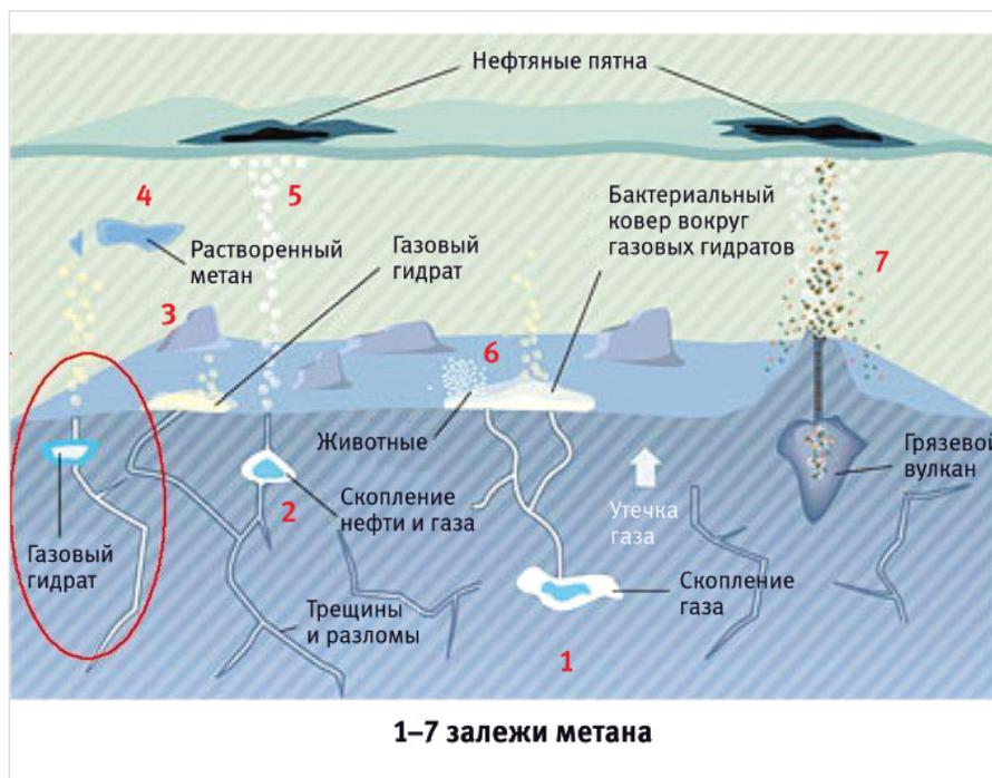
Рис. 2. Места образования залежей газовых гидратов [17]
