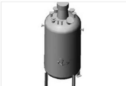
Рис. 3 — Аппарат реакторного типа с механическим перемешивающим устройством
