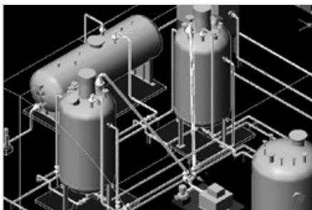
Рис. 2 — Пример расположения оборудования в реакторном блоке
