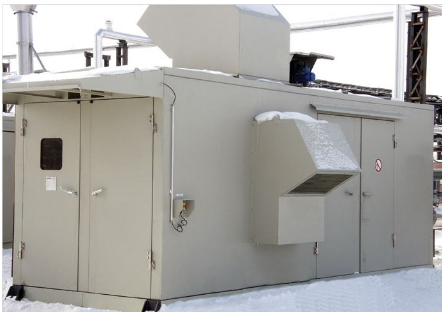
Фото 3. Малая газоконпрессорная установка «ЭНЕРГАЗ» работает в тяжелых климатических условиях
