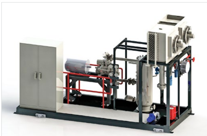
Рис. 1. 3D-модель малой газокомпрессорной установки на открытой раме
