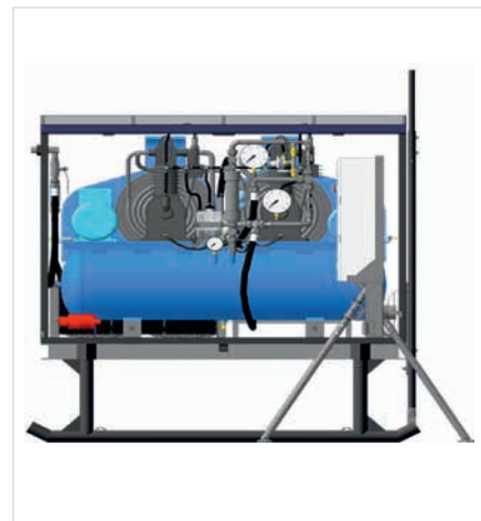
Рис. 2 — Общий вид комплекса по отбору газа из скважин Fig. 2 — General view of set of equipment for gas extraction from wells
