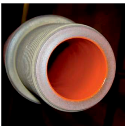
Рис. 2 — НКТ с нанесённым праймером на внутреннюю поверхность
