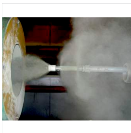
Рис. 5 — Электросаждения порошка на внутреннюю поверхность НКТ
