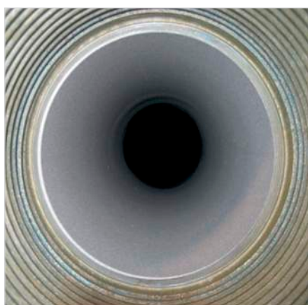
Рис. 1 — Очищенная внутренняя поверхность НКТ для полимерного покрытия
