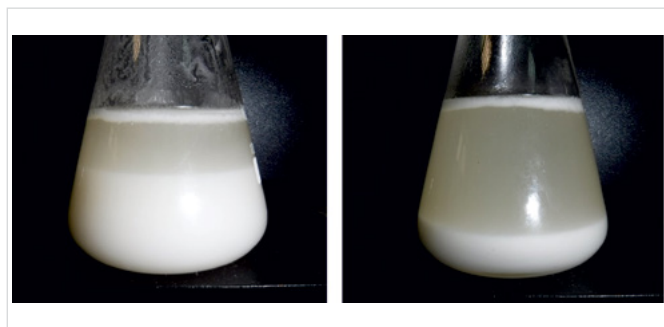
Рис. 5. Внешний вид ТЖГ, не допущенных до комплекса ЛИ: происходит выпадение осадка, снижение целевой плотности ТЖГ Fig. 5. Appearance of heavy killing liquids not admitted to the set of laboratory tests: there is precipitation, decrease in the target density of the heavy killing liquid
