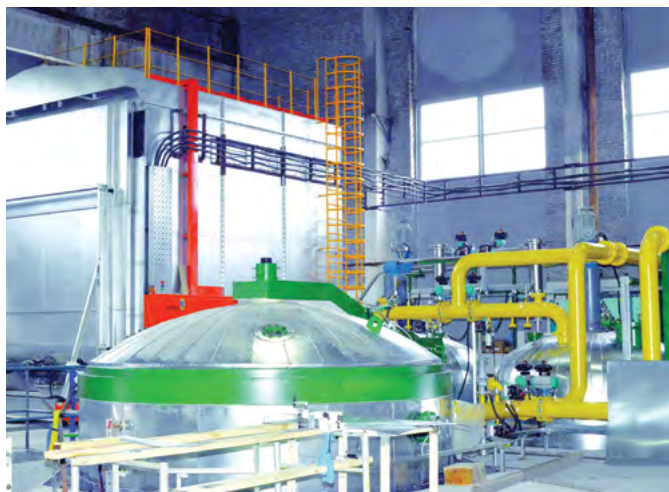
Фото 2. Современный комплекс для изоляции элементов электромашин по технологии VPI (вакуумно-нагнетательная пропитка)
