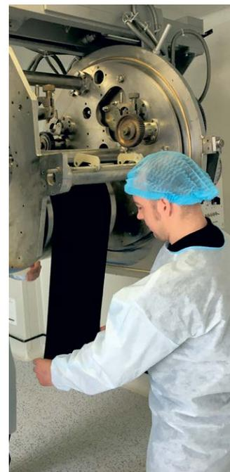
*Нанесение тонкопленочных материалов путем магнетронного напыления*
