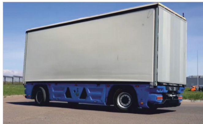
Рис. 3. Беспилотный грузовик на электрической тяге КАМАЗ-3373 «Челнок» [10] Fig. 3. Unmanned truck with electric traction KAMAZ-3373 "Shuttle" [10]
