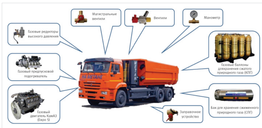
Рис. 1. Пример грузового автомобиля, работающего на газомоторном топливе [3, 4] Fig. 1. An example of a truck running on gas engine fuel [3, 4]
