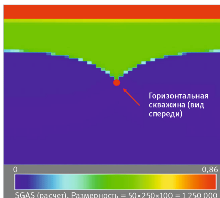
Рис. 6. Профиль газонасыщенности при работе скважины на критической депрессии, рассчитанной при помощи подбора контроля по депрессии Fig. 6. Gas saturation profile when the well produces at a critical depression, calculated using selection of depression control
