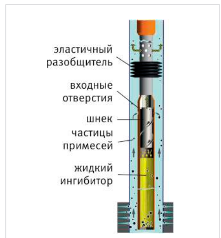
Рис. 6 — Контейнер скважинный со шнеком
