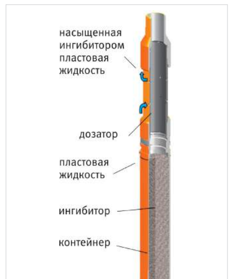
Рис. 4 — Контейнер с капсулированным реагентом
