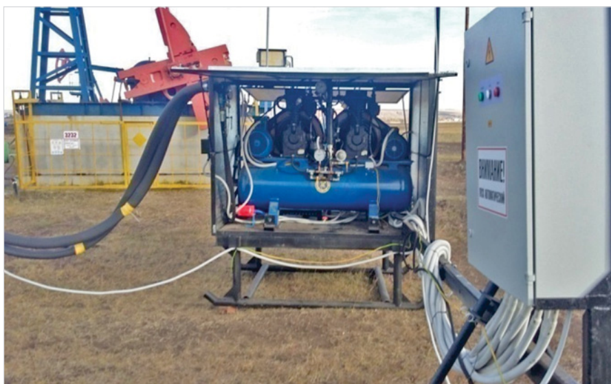
Рис. 4. Соединение утепленных рукавов с КОГС
