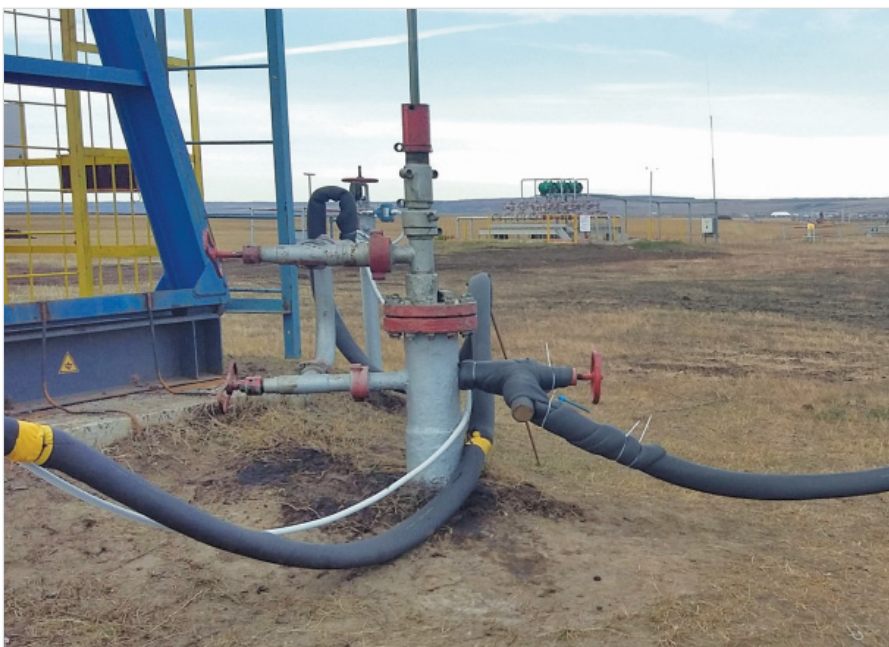
Рис. 5. Утепление затрубной задвижки
