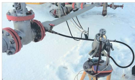
Рис. 3 — Процесс замера вязкости жидкости вискозиметром на устье скважины
