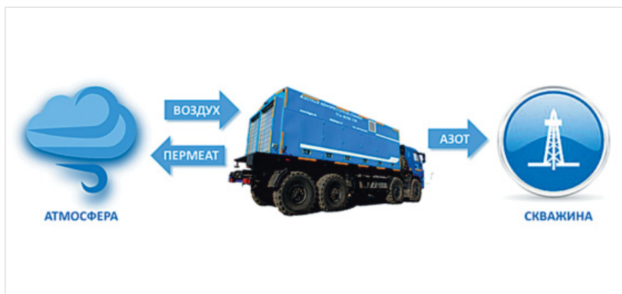
Рис. 2. Схема процесса получения газообразного азота из воздуха
